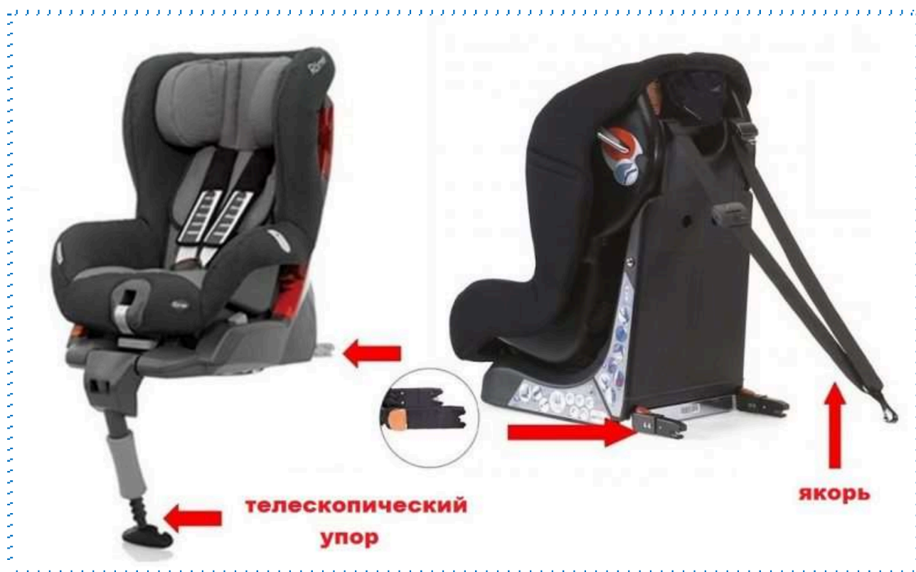
Рисунок 6. Телескопический упор и якорное крепление
